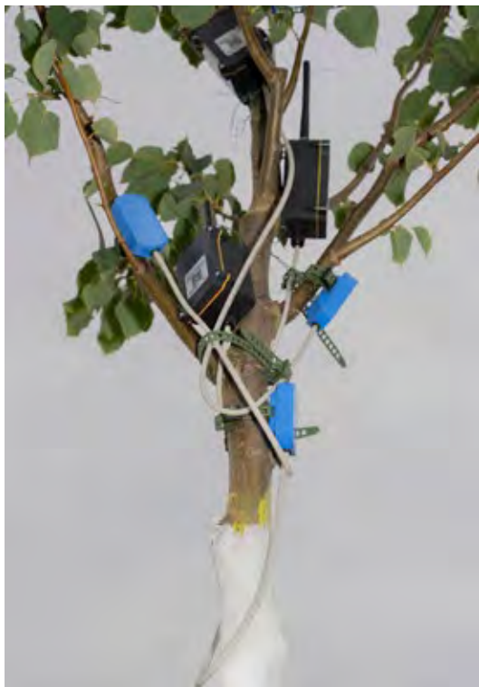
Beim Alleeforschungsprojekt in Müncheberg (Brandenburg) wird mit Sensoren unter anderem der Saftstrom der Bäume gemessen.
