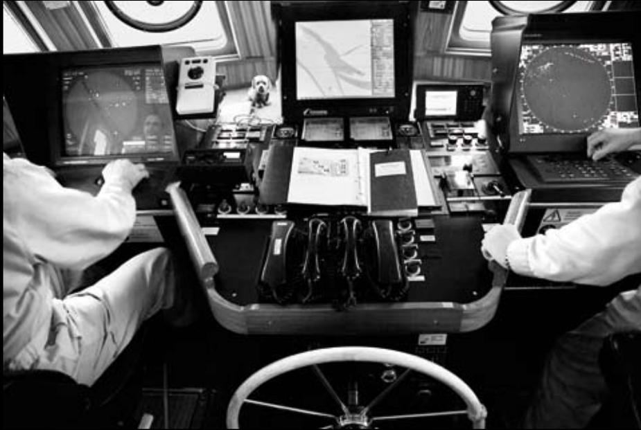
**Moderne Technik auf der Brücke** Die „Hermann Rudolf Meyer“ kann nicht nur mit dem Steuerrad manövriert werden sondern auch mit einem fingerlangen Joystick.
