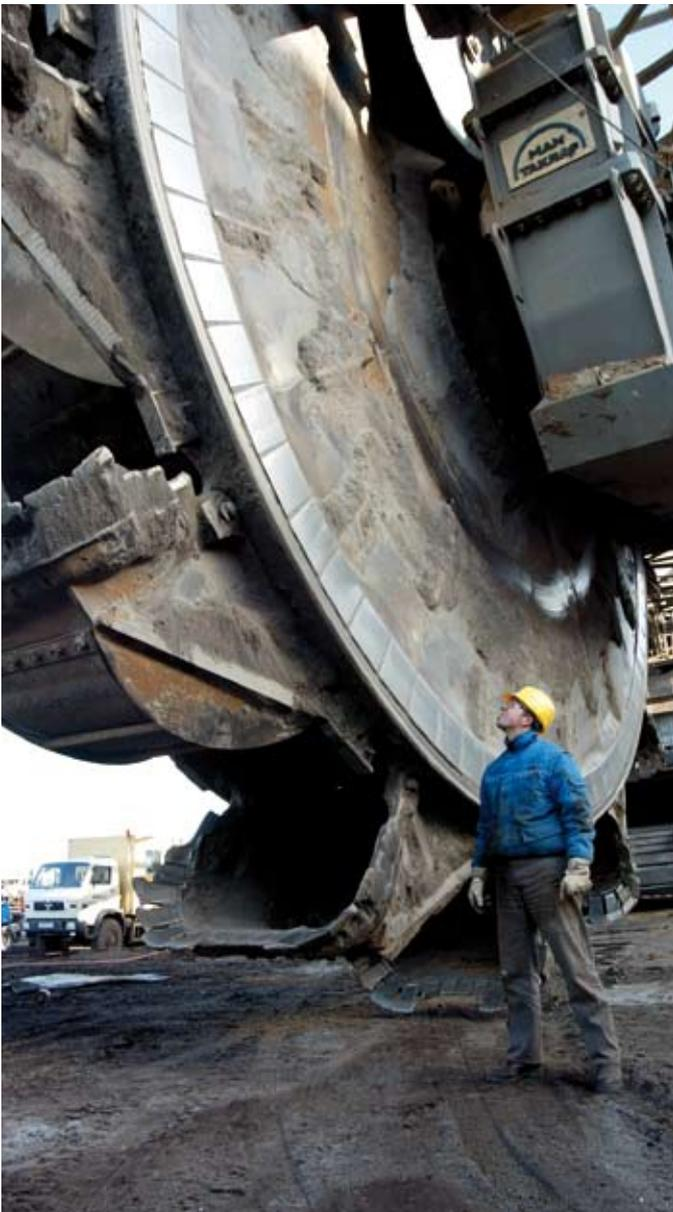
Schaufelrad des Baggers SRs 2000
