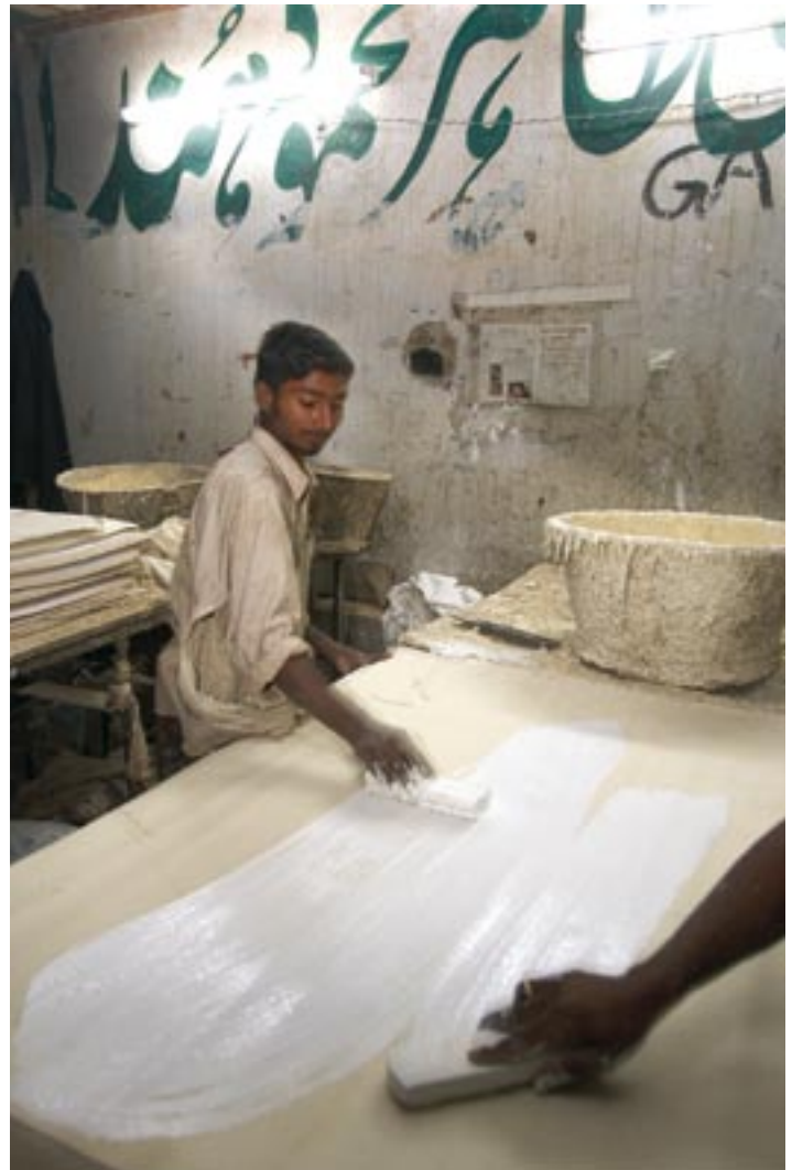
PVC-Matten werden mit Latex bestrichen und mit Baumwolltüchern belegt, aus denen dann die Waben gestanzt werden.
