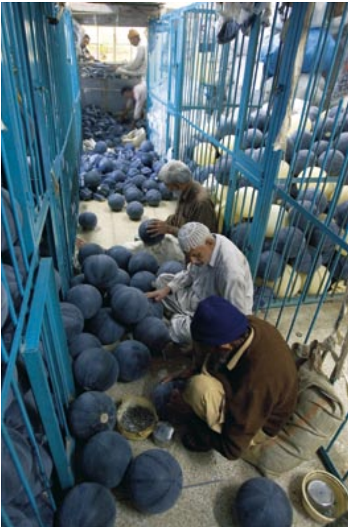
Arbeiter prüfen, ob die Innenblasen dicht sind.
