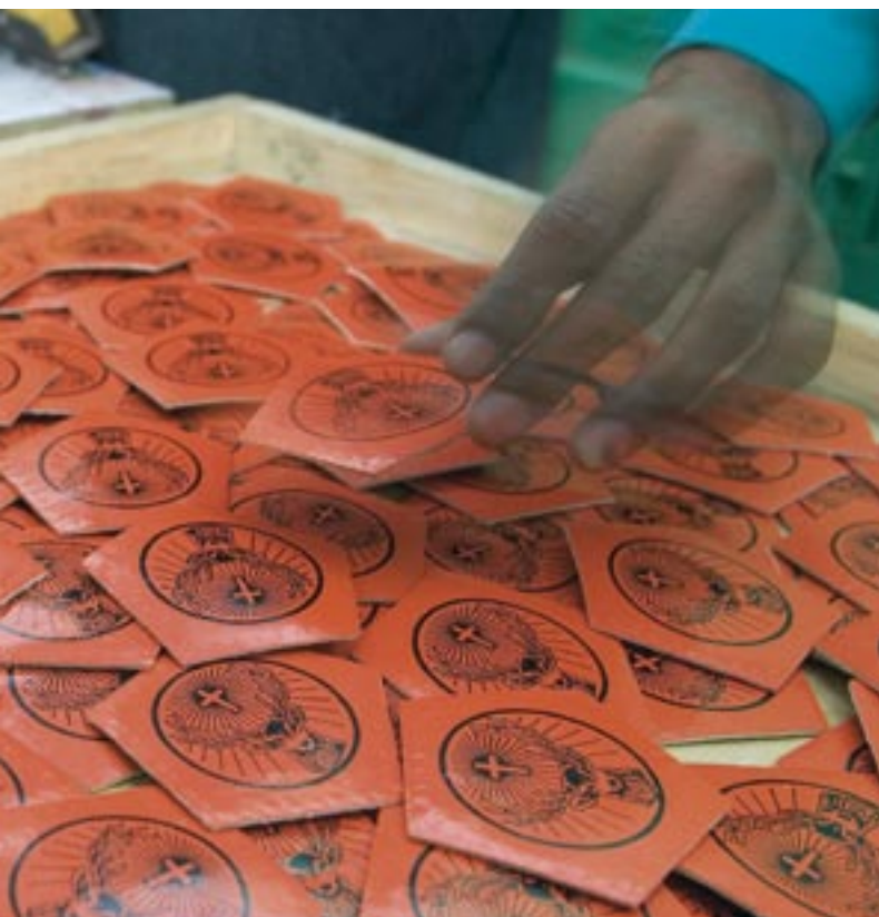
Ein Jägermeister-Ball besteht aus 32 Waben, die mit 650 Stichen zusammengenäht werden.
